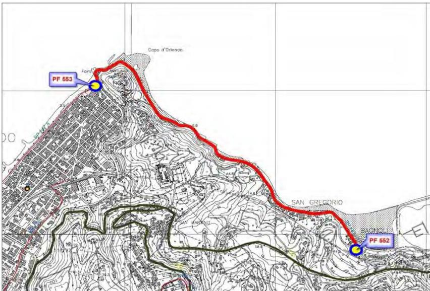
La S.P. 147 di San Gregorio inizia dalla S.S. 113 al km 102+100 e termina alla S.P. 147/a km 0+000 (Via del Faro – Capo d’Orlando). Ha un dislivello di 8 m ed una pendenza media del 0,32%. Il suo percorso di km 2+504, si snoda con sviluppo ed andamento planoaltimetrico con sezione a mezza costa e ricade interamente nel Comune di Capo d’Orlando.
